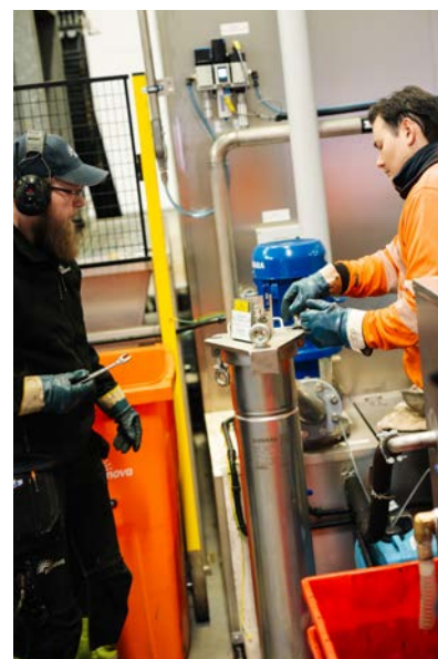
Tobias Tarnvik-Laesker och kollegan Stefan Pendarar byter filter på den helautomatiska LOTS-behållartvätten.
