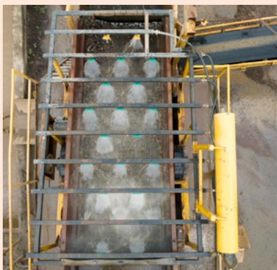
Schaktmassorna siktas och spolas med vatten.
